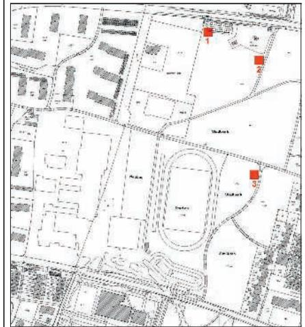
Zur Erkundung der Verhältnisse am Standort sollen sowohl die Verfügbarkeit von Grundwasser, als auch der tiefere Untergrund untersucht werden. Zur Ermittlung der Grundwassererfügbarkeit werden im nördlichen Stadtpark zwei Grundwasserstellen mit einer Tiefe von voraussichtlich etwa 20 m errichtet. Bei positivem Befund werden an diesen Messstellen im April Pumpversuche durchgeführt und die Qualität des Grundwassers untersucht.
